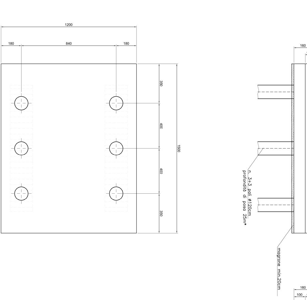
N.B. TIPO CLS E ARMATURA DA DEFINIRE IN FUNZIONE DELLE CARATTERISTICHE DEL TERRENO
