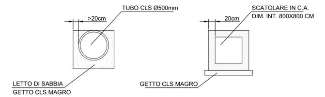
N.B. ove necessario è possibile accoppiare i tubi o gli scatolari per aumentare la portata del condotto
