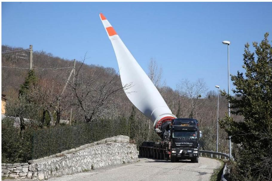
**Figura 8 - Esempio di un mezzo semovente, trainato da trattore stradale, con pala inclinata.**
