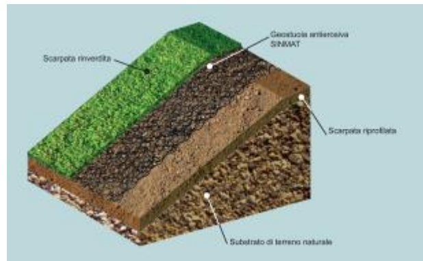
Figura 4 - schema struttura geostuoie
