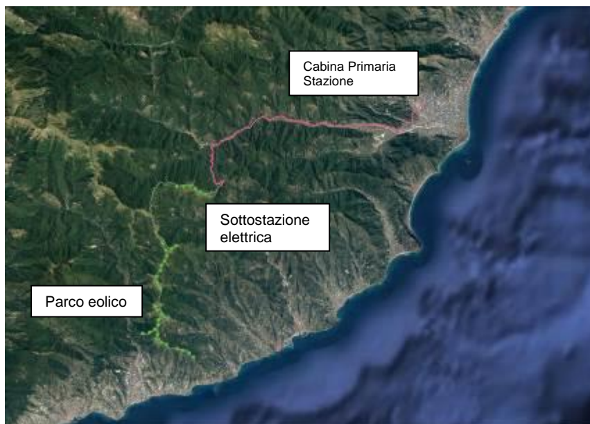
— Connessione elettrica — Viabilità interna
