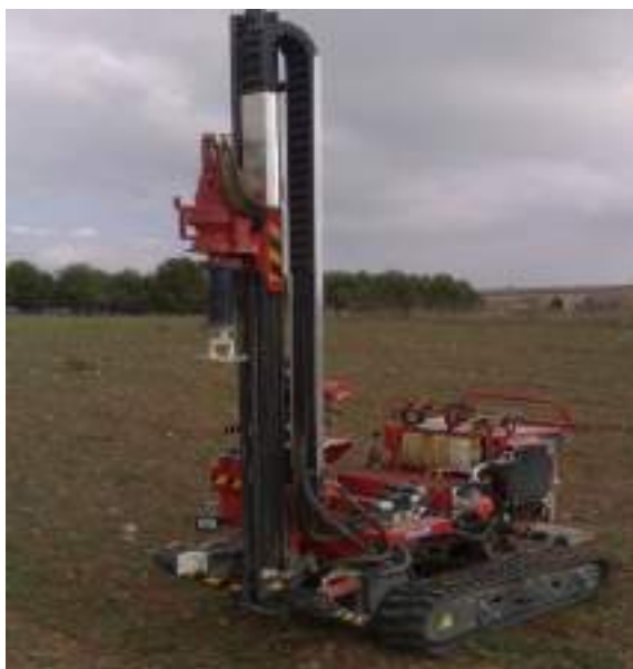
Figura 38 – MACCHINA BATTIPALO PER INFISSIONE PALI
