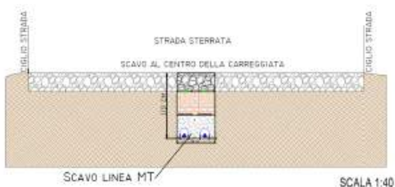
Scavi cavidotti MT
