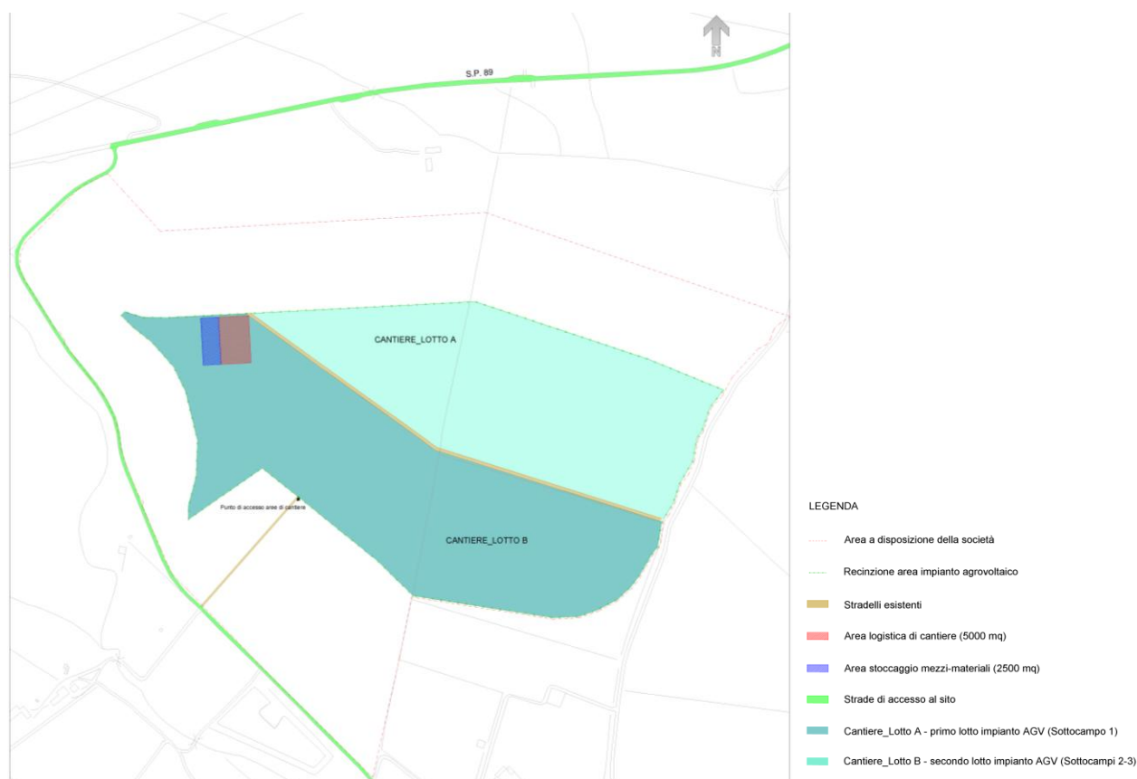
Figura 14: Indicazione aree di cantiere sito di intervento.
