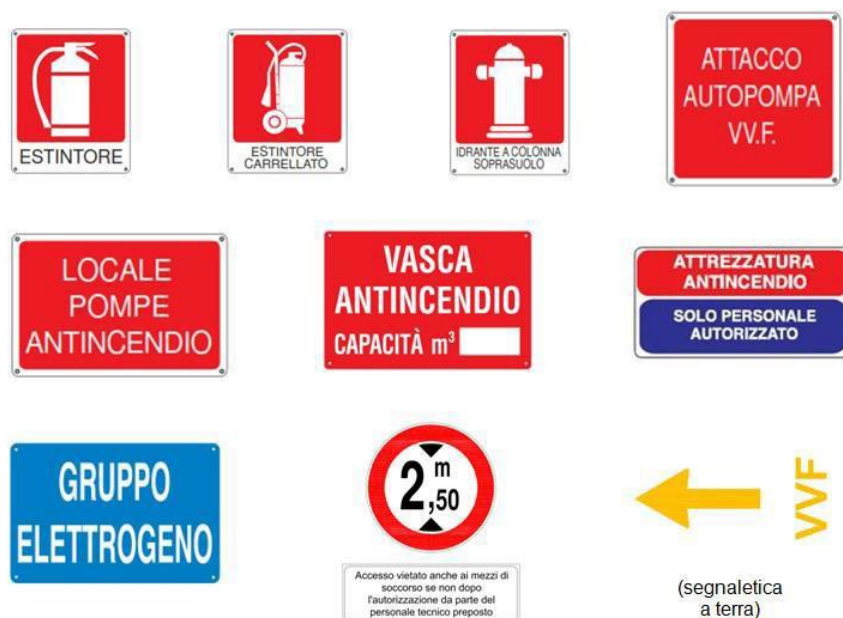
Figura 1: Esempi di segnaletica di sicurezza.
