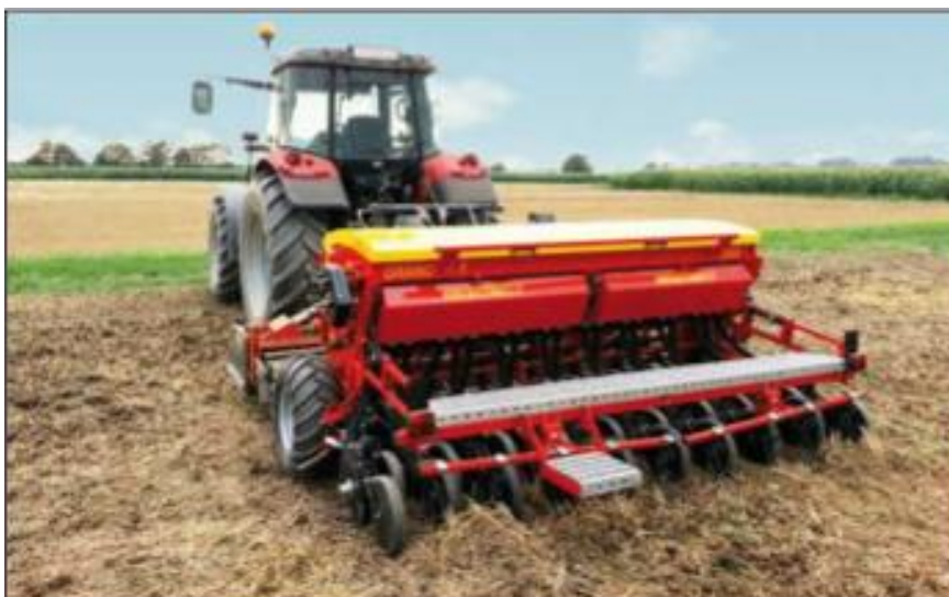
Figura 15: Esempio di seminatrice di precisione per tutte le tipologie di sementi.
