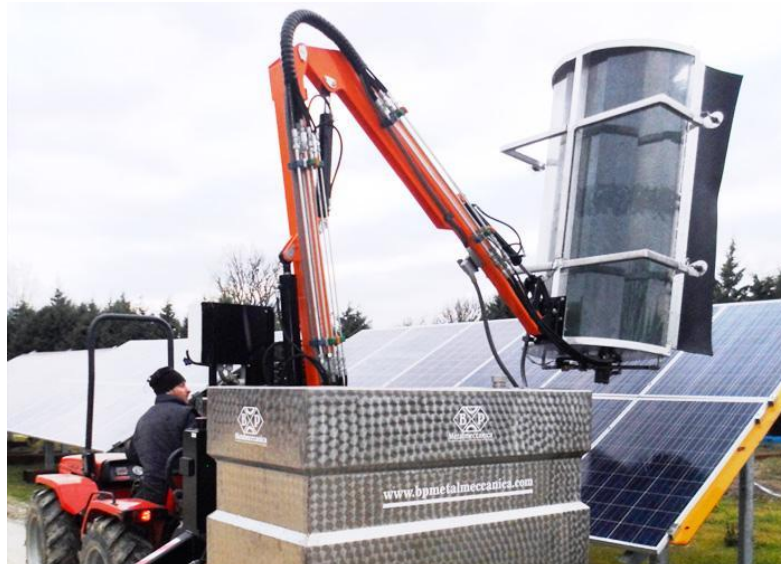
Figura 11: Esempio di macchina pulitrice applicabile a trattrici agricole
