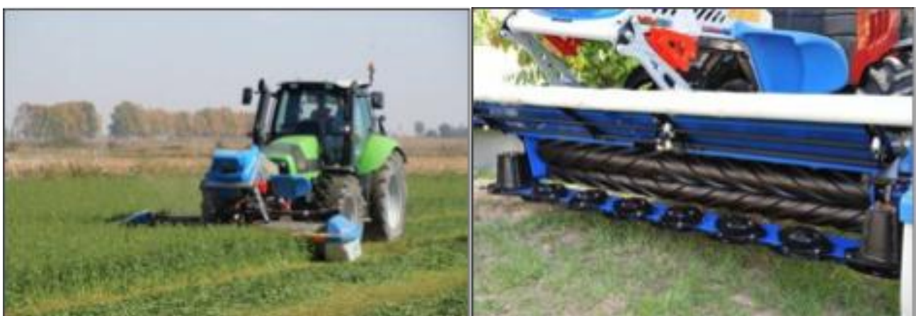
Figura 17: Esempio di falciaccondizionatrice frontale e particolare dei rulli in gomma.
