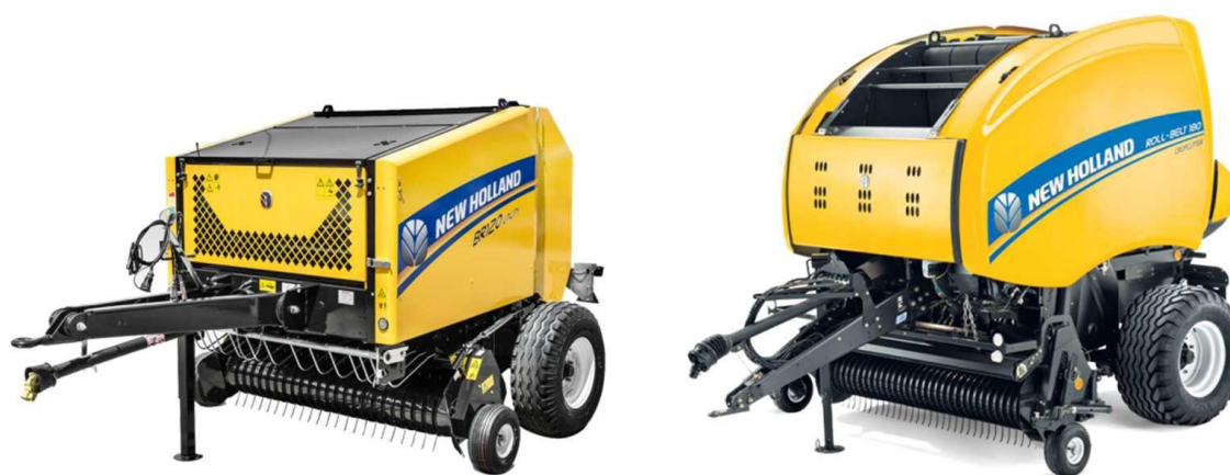
Figura 18: Rotoimballatrici a camera fissa (a sinistra) e a camera variabile (a destra) prodotte dalla CNH e relative caratteristiche dimensionali.
