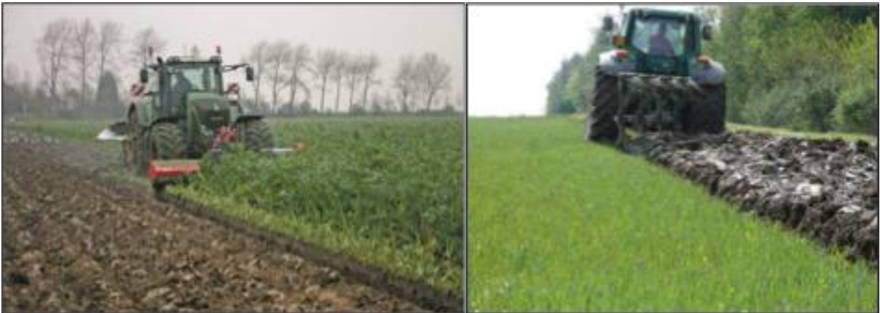
Figura 14: Esempio di pratica del sovescio in pieno campo. Si noti, a sinistra, l'impiego di una trincia frontale montata sulla stessa trattrice per alleggerire il carico sull'aratro portato.
