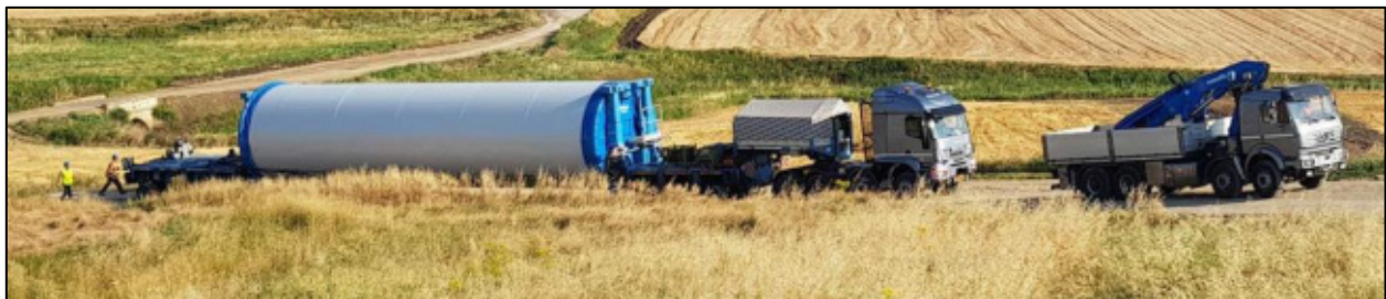
Figura 96 - Esempio di camion eccezionale coinvolto per il trasporto delle componenti delle torri eoliche
