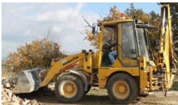
Escavatore caricatore (Terna)
