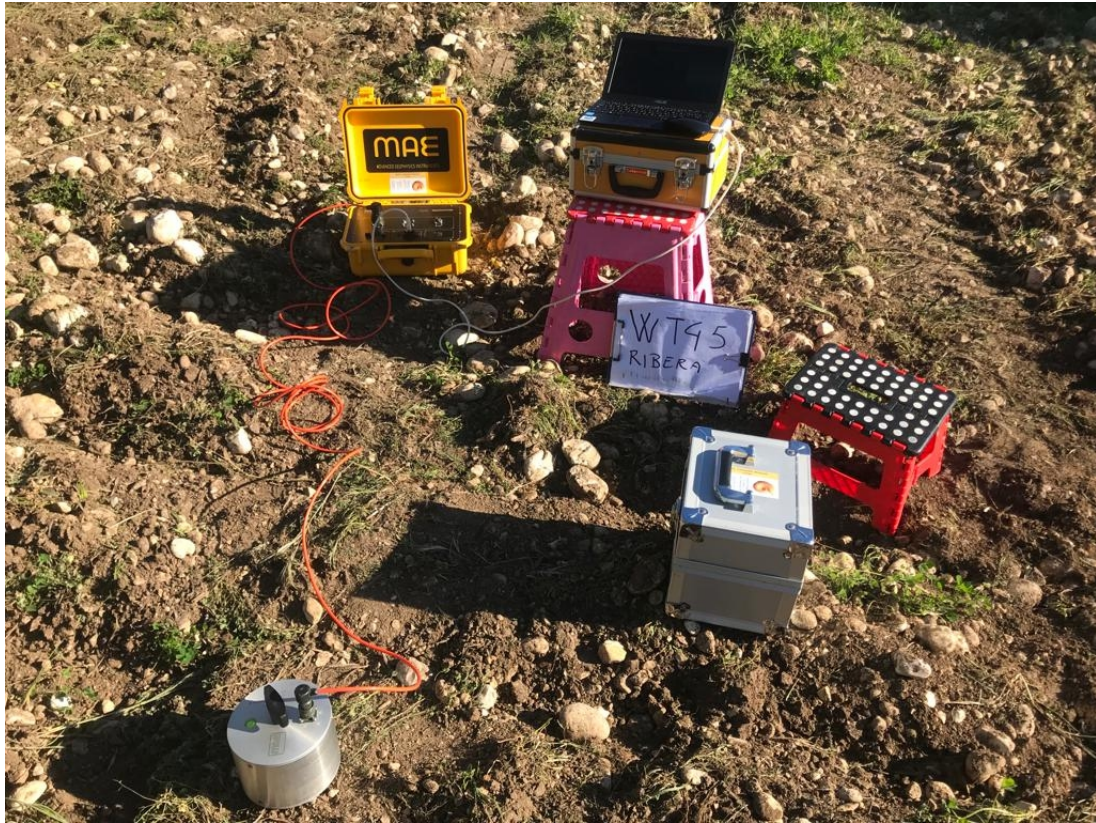
Misura di sismica passiva HVSR WTG 5
