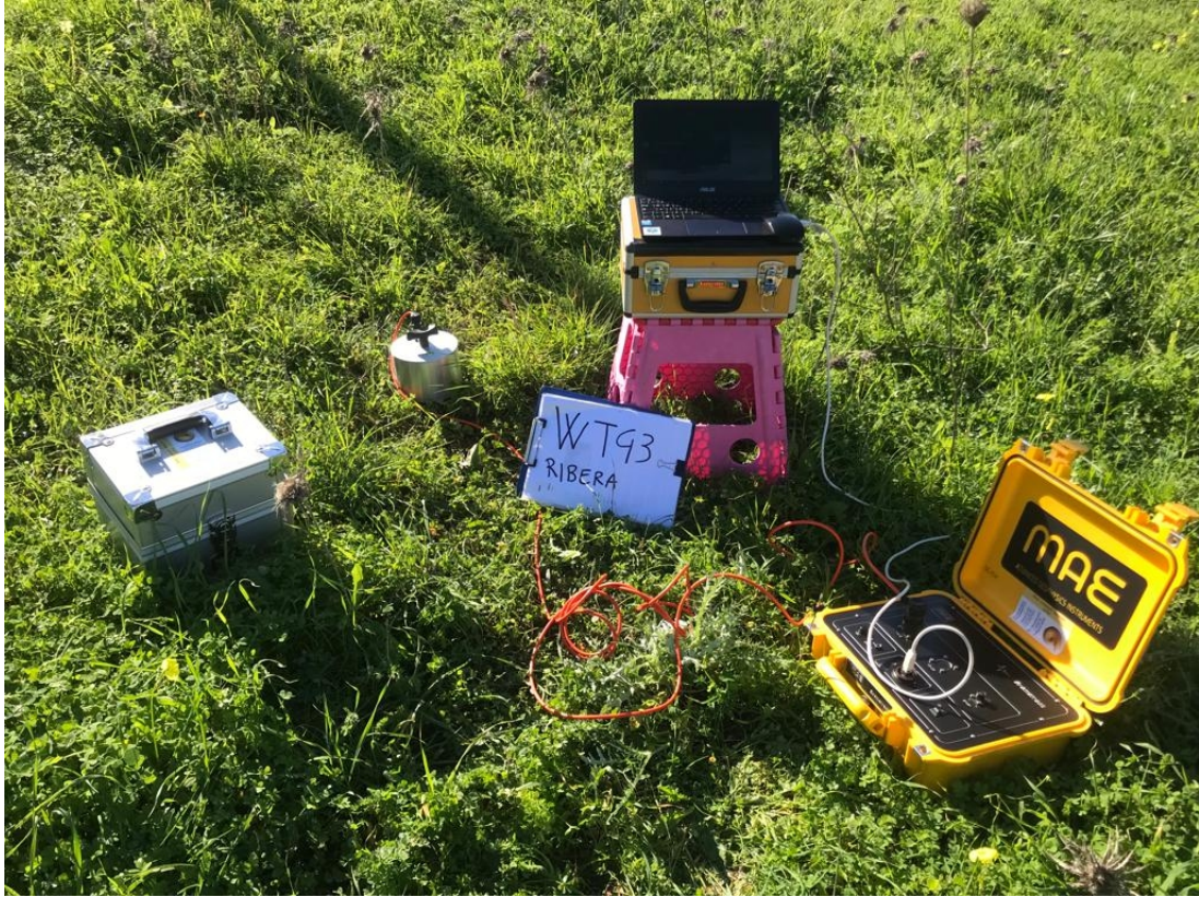
Misura di sismica passiva HVSR WTG 3
