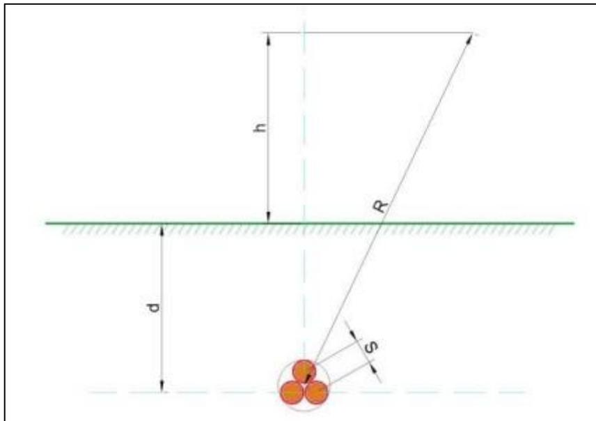
Figura 3 - Modello di calcolo per 1 terna a trifoglio
