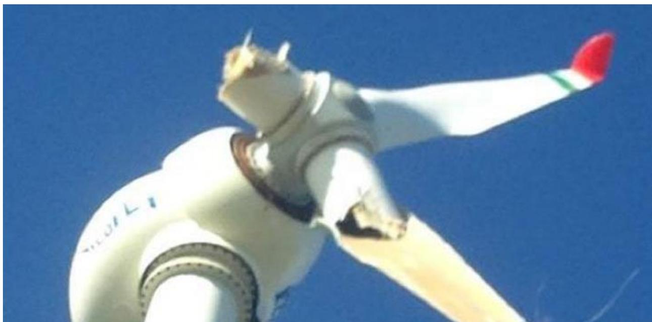
*Figura 5- Esempio di rottura alla radice*
