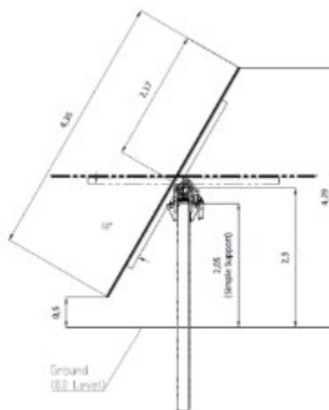
Figura 3 – Sezione tipo tracker
