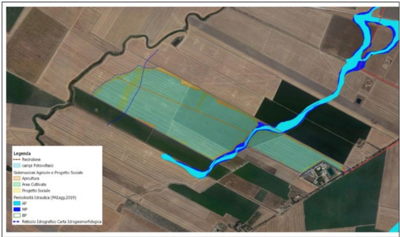
Figura 15 Ortofoto con rappresentazione delle aree a pericolosità idraulica (PAI Puglia - aggiornamento 2019) e reticolo idrografico della Carta Idrogeomorfologica della Regione Puglia
