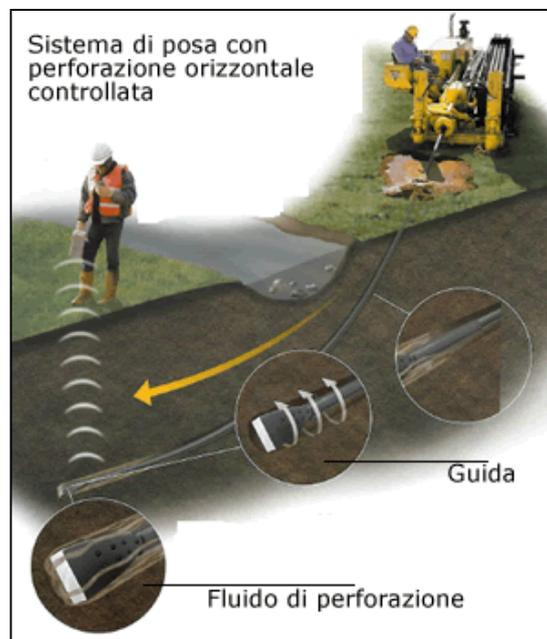
Figura 3-1 – Macchina perforatrice
