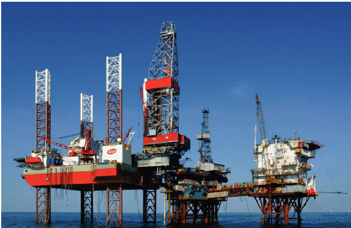
Figura 4.1: Piattaforma Mobile Jack-Up Tipica - "GSP Jupiter" (modificato da Sito web www.gspoffshore.com )
