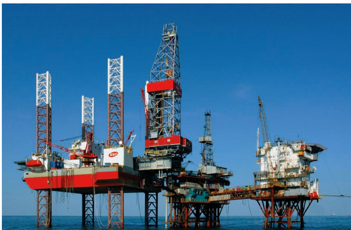
Figura 5.1: Piattaforma Mobile Jack-Up Tipica - "GSP Jupiter"
