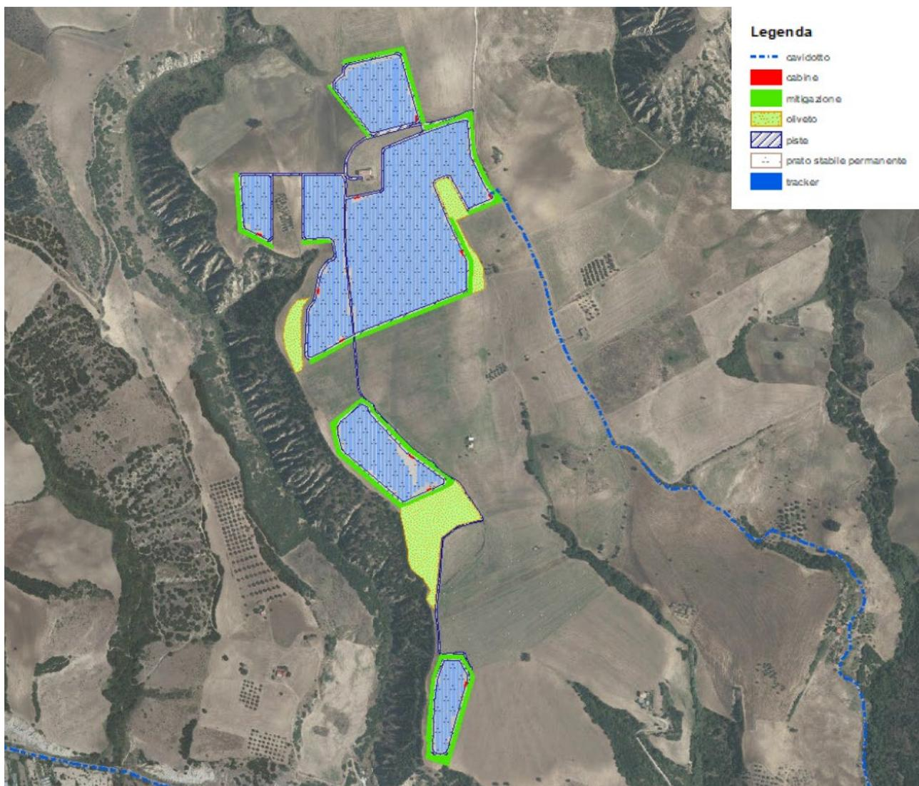
Figura 1 -- Area di progetto con indicazione degli interventi agronomici e posizionamento dei moduli fotovoltaici
