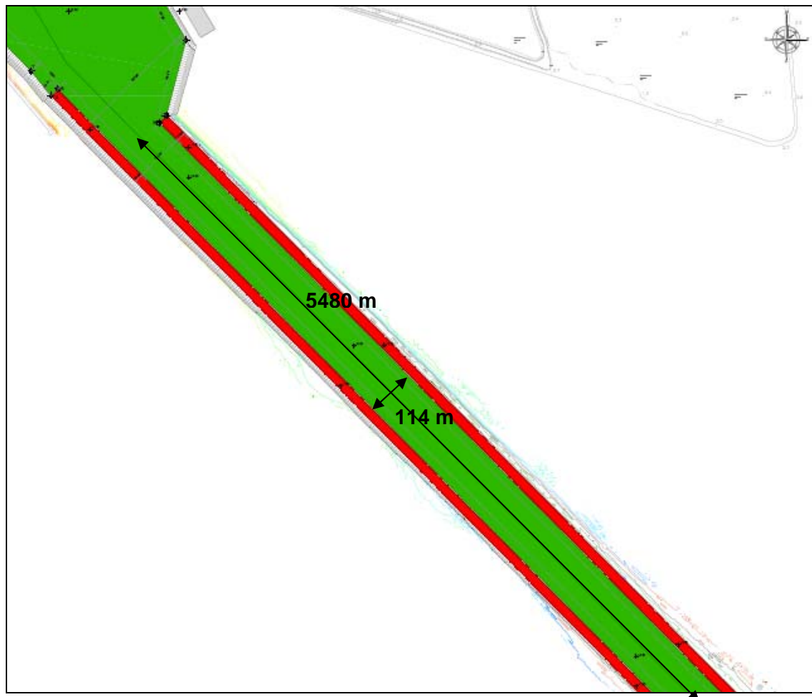
Figura 8.h: Dragaggio del Fondale Marino – Zona Canale di Accesso
