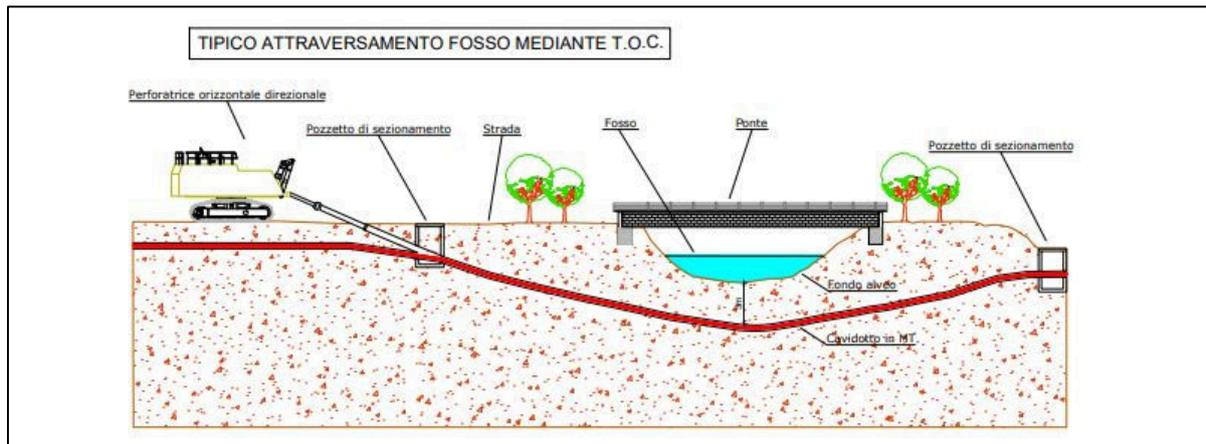
Figura 8: Attraversamento tipo mediante tecnica TOC dei fossi
