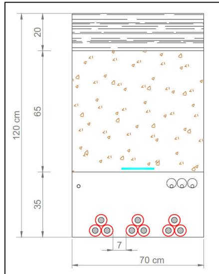
*Figura 6: Sezione tipo del cavidotto interrato MT composto da n.3 terne di cavi su strada sterrata*
