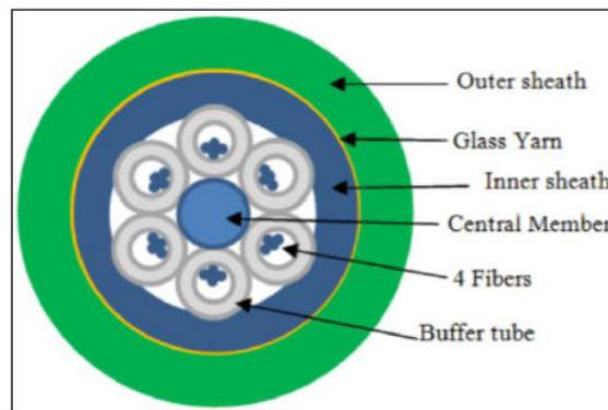
Figura 11: Caratteristiche del cavo in F.O.
