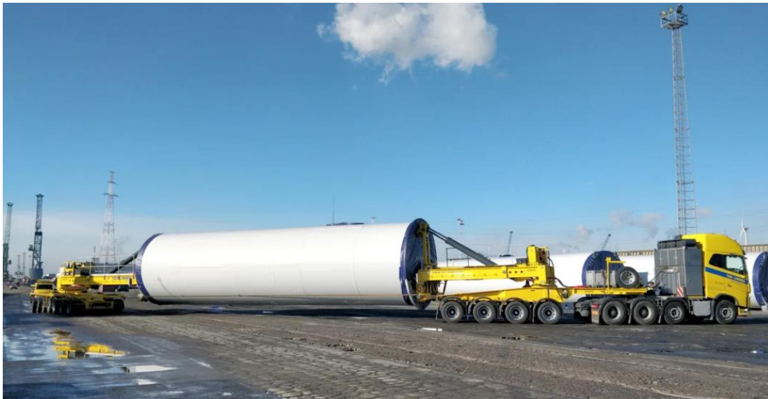
Figure 14 – Trasporto sezione torre
