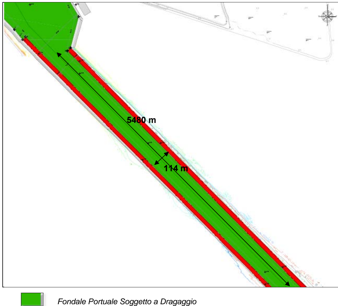
Figura 2.c: Dragaggio del Fondale Marino – Zona Canale di Accesso
