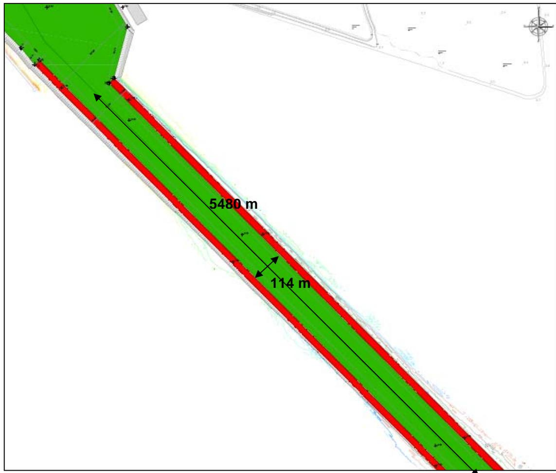
**Figura 2.c: Dragaggio del Fondale Marino – Zona Canale di Accesso**
