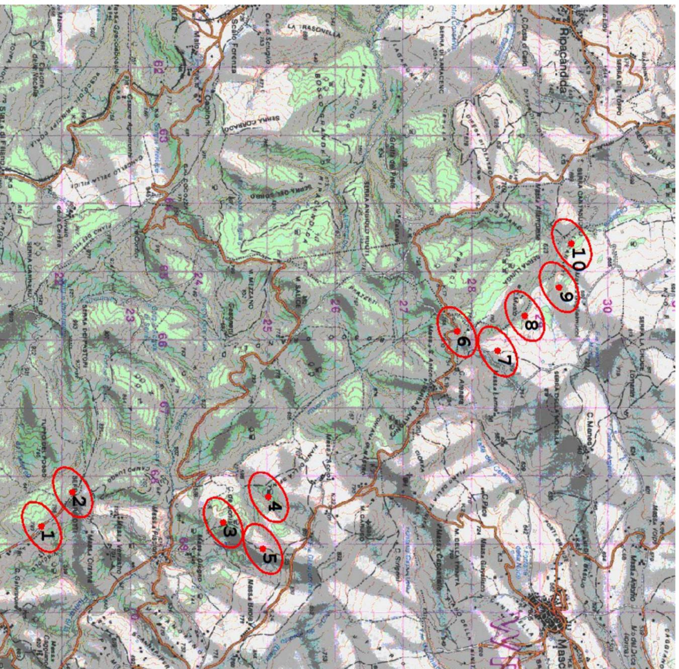
Rappresentazione del Lay-out del Parco eolico Piano della Spina su carta IGM con indicazione delle ellissi corrispondenti a 2,5 diametri (405m) della direzione prevalente del vento (240° vedi A5 "Relazione Anemologica") e 1,5 diametri (243m) nella direzione ortogonale. Il rispetto delle distanze minime indicate dalle Linee Guida Nazionali (3D e 5D) è dato dalla non intersezioni delle singole ellissi.
