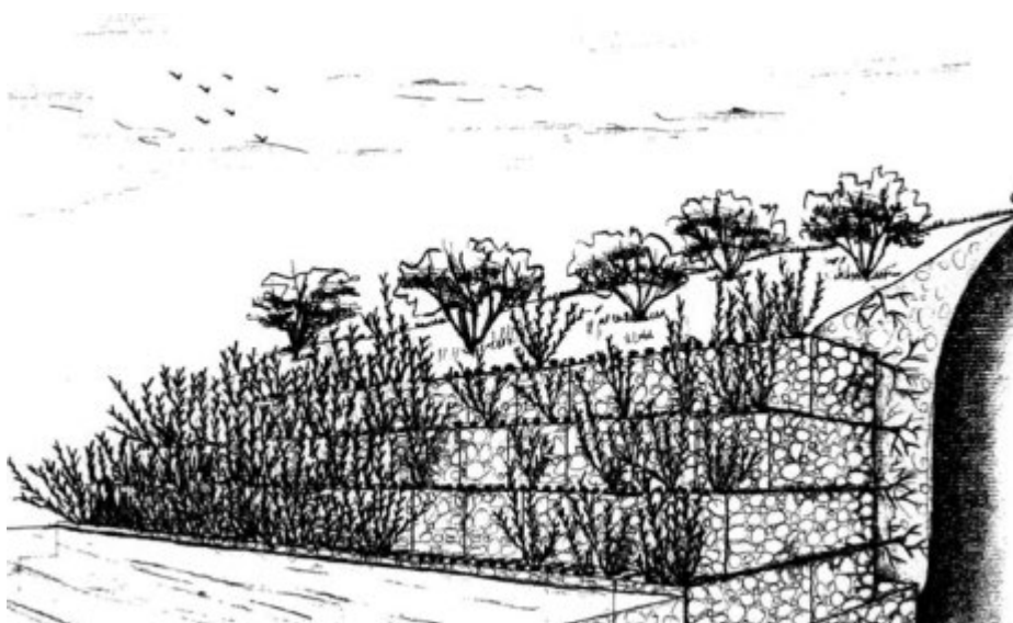
Figura 2: Vista in prospettiva di Gabbionata in rete metallica zincata rinverdita (Manuale di ingegneria naturalistica applicabile al settore idraulico – scheda 31– Regione Lazio, 2003)
