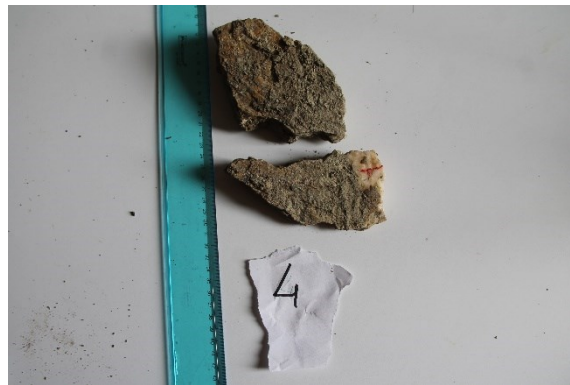
In alto, campione di slickenside mineralizzato raccolto lungo la faglia N60E sub-verticale
