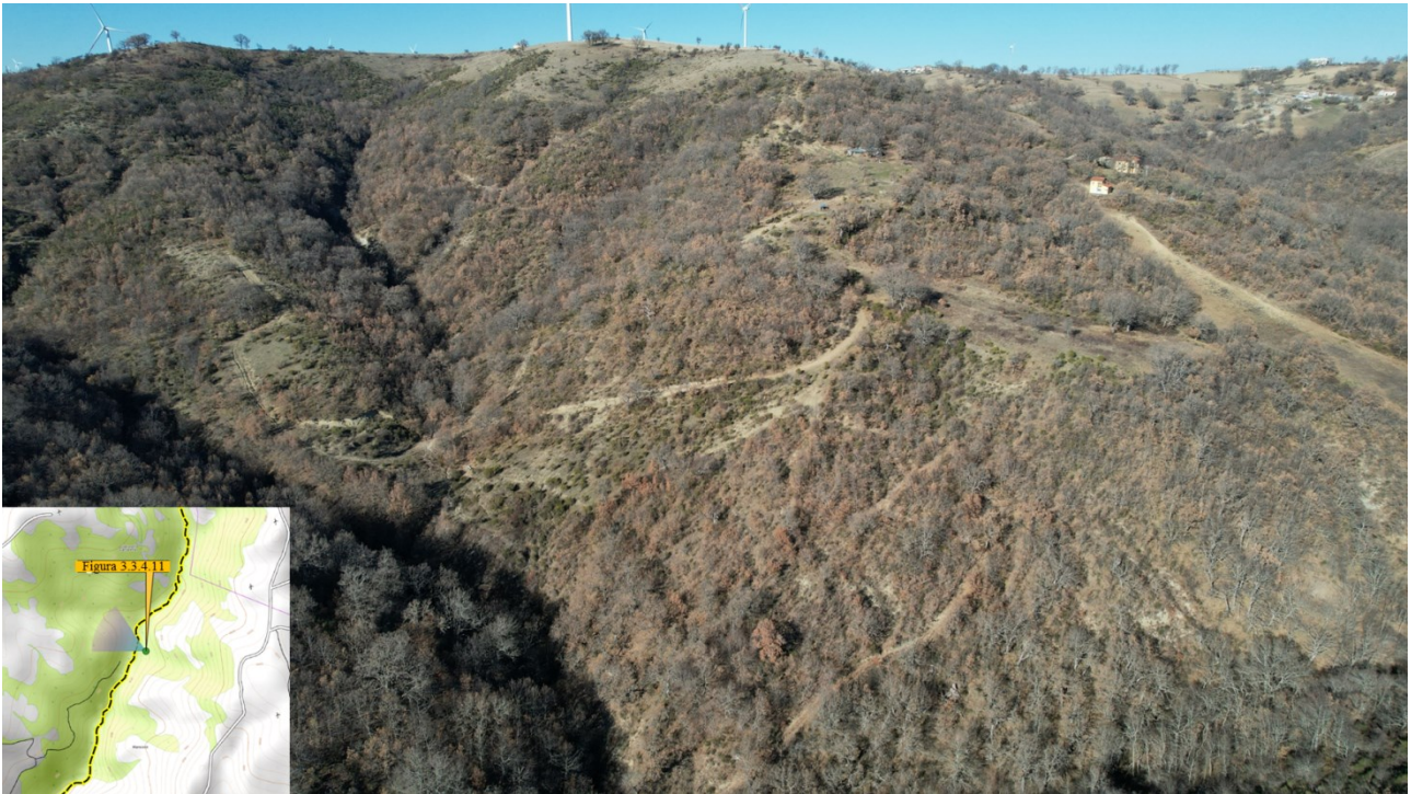
Figura 3.3.4.11 – Versante orientale caratterizzato da una franosità con cinematismo lento e da aree soggette a deformazioni lente e diffuse. In basso a sinistra è riportato il riquadro mostrante il punto di osservazione.
