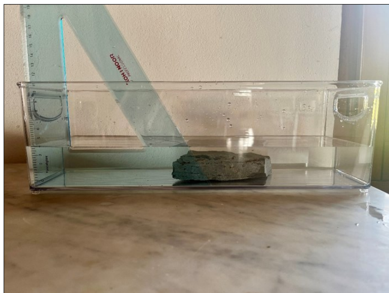
Figura 2.4.1.1.1 - Misurazione effettuata utilizzando il metodo dello spostamento d’acqua.
