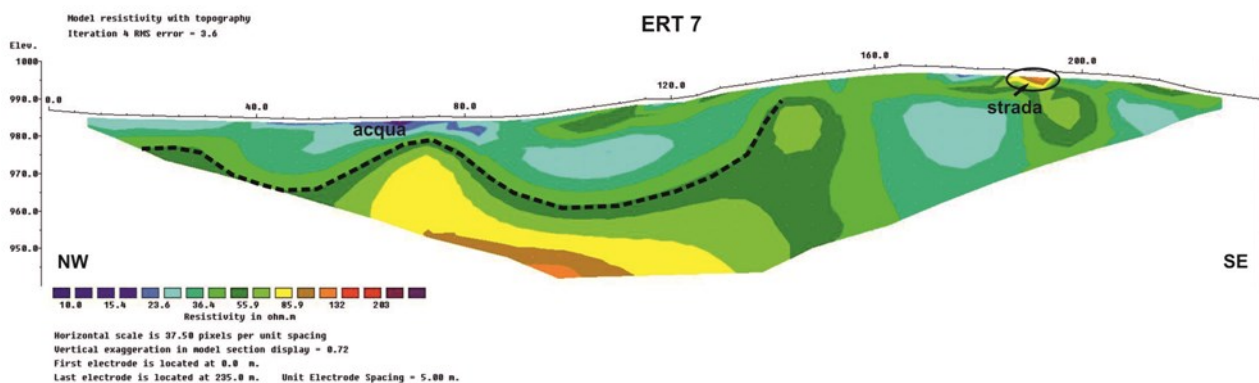
Figura 3.2.2.3.2 - Modello di inversione della ERT7 ottenuto con il dispositivo Wenner-Schlumberger.
