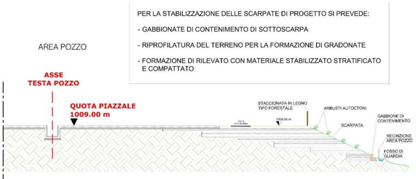
Fig. 31 - Sezione tipo area pozzo
