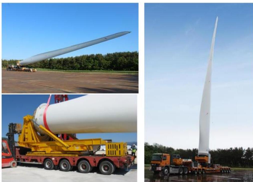
Figura 10. Trasporto con blade lifter (fonte: <https://www.faymonville.com/technologie/bladelifter-il-blademax/>)
