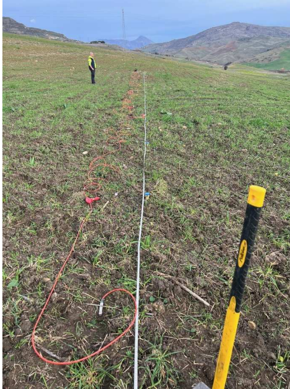
INDAGINE SISMICA MASW1
