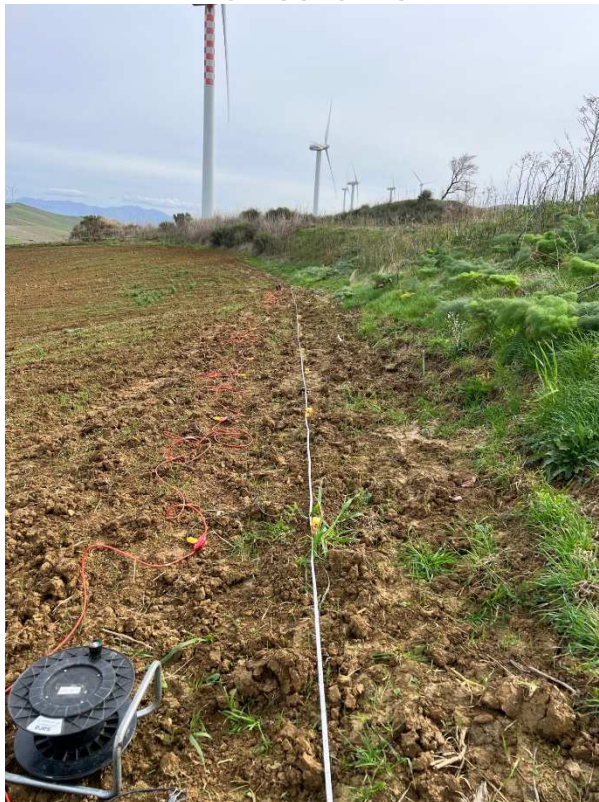
INDAGINE SISMICA MASW2
