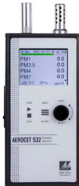
Fig. 5-3: Strumentazione tipo per la misura del particolato in continuo.
