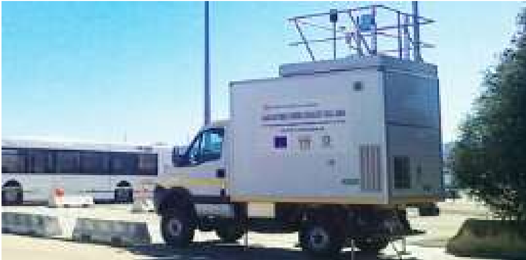
Fig. 5-4: Stazione mobile per il monitoraggio degli inquinanti da traffico veicolare, polveri e meteoclima
