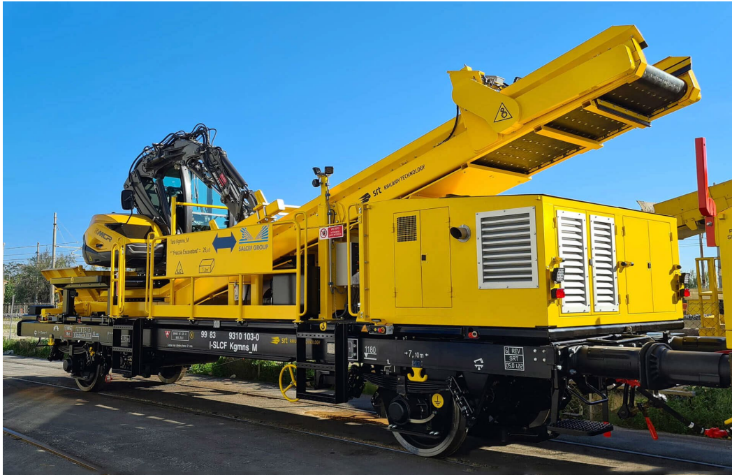
Figura 6 - Esempio di escavatore con nastro di carico.
