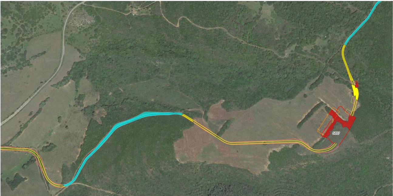
*Figura 2: Esempio di fotointerpretazione per il rilievo delle aree boscate in ambiente GIS*
