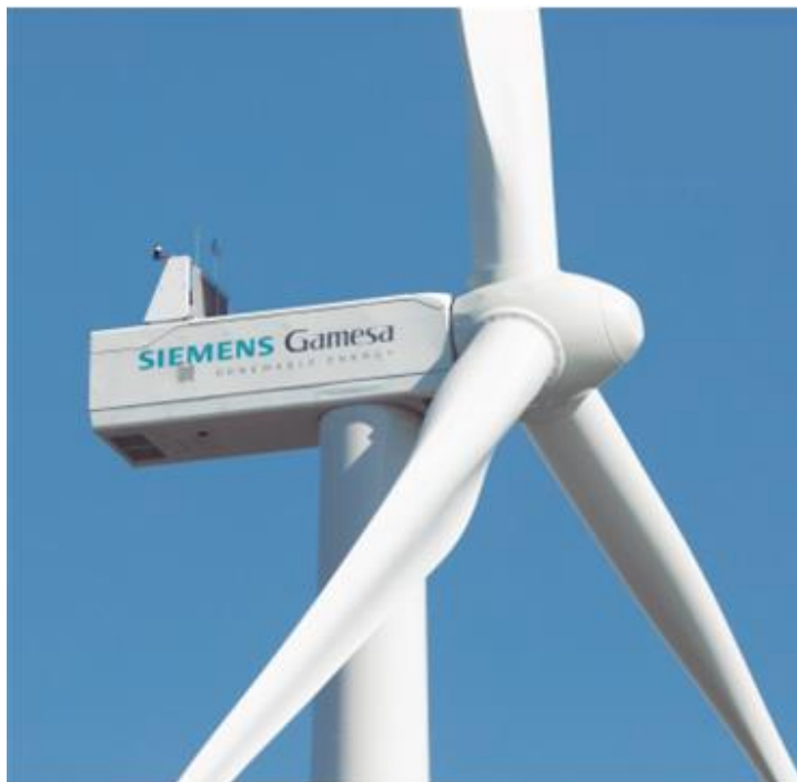
Figura 3.1– Aerogeneratore Siemens-Gamesa tipo SG 6.6 -170
