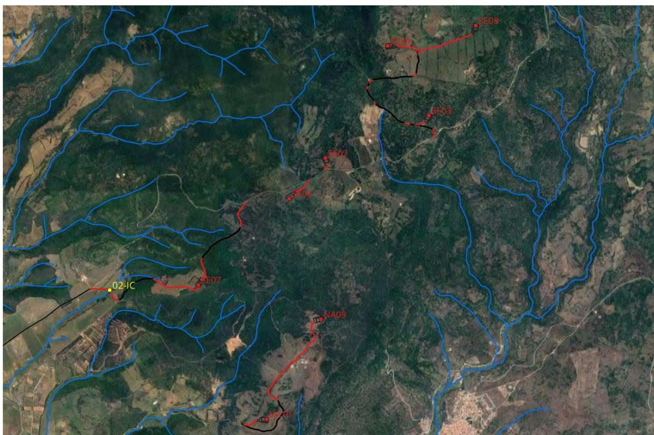
Figura 1.1: Planimetria di progetto su ortofoto con individuazione del reticolo idrografico della Regione (in rosso la viabilità di progetto da realizzare, in nero la viabilità da adeguare)
