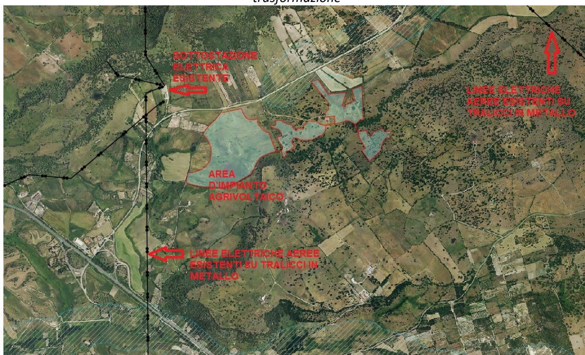
Planimetria della zona d'intervento con evidenziata, in rosso, la presenza della sottostazione elettrica di trasformazione e delle linee elettriche aeree su tralicci in metallo (immagine tratta dal Geoportale Sardegna)
