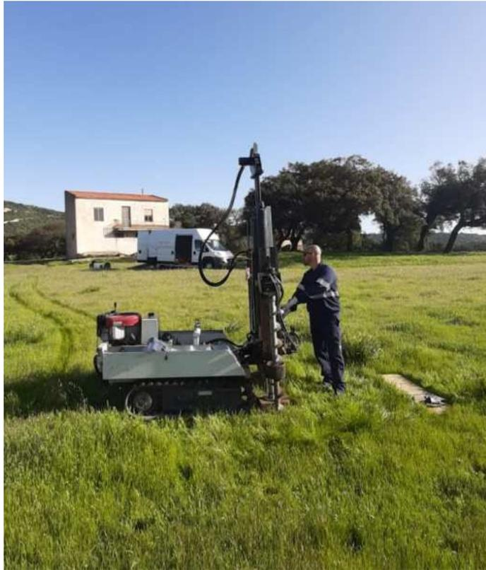
***Prova penetrometrica dinamica continua DPSH -2***
