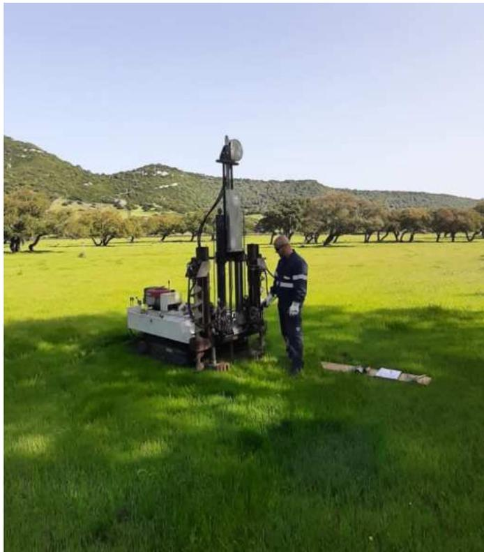
***Prova penetrometrica dinamica continua DPSH -3***
