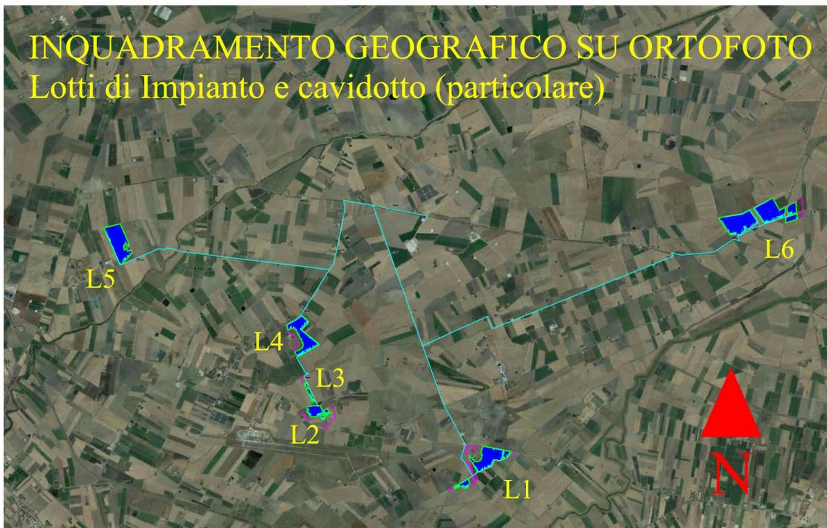
Figura 5. Lotti di impianto su ortofoto in dettaglio. La linea di collegamento di colore ciano rappresenta il percorso del cavidotto
