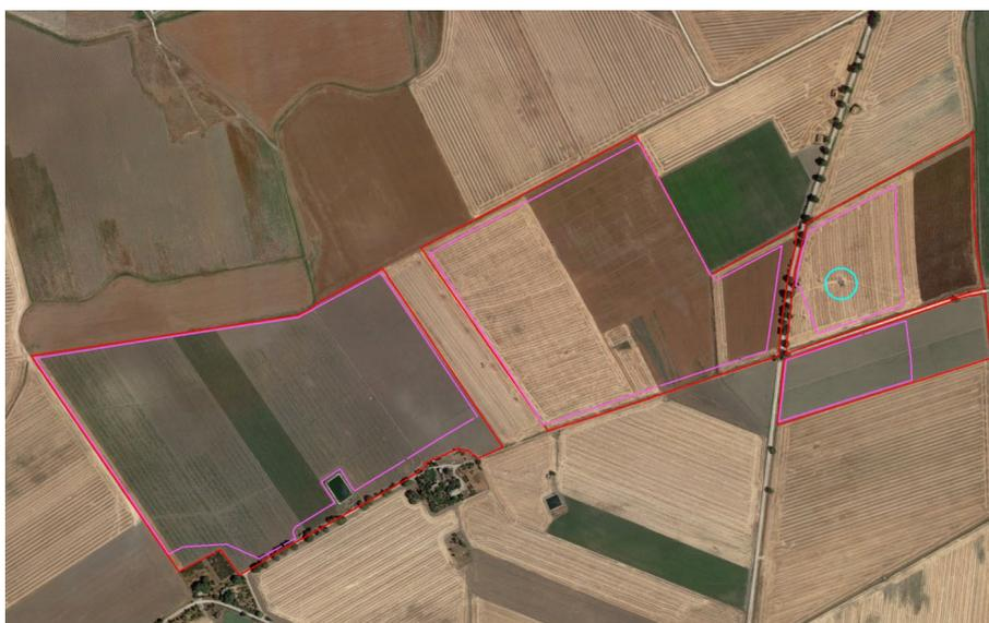
**Figura 46 – Probabile presenza di linee elettriche BT interrato (in ciano). In rosso l'area di impianto; in magenta l'area utile che verrà occupata dal layout di impianto.**
