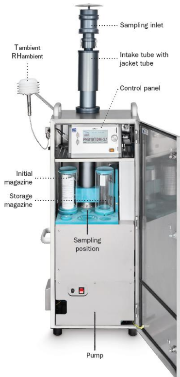
Figura 4-1 Campionatore sequenziale automatico
