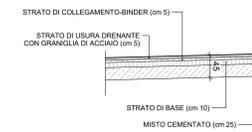
**SEZIONE TIPO CON CORSIE DI ACCELERAZIONE E DECELERAZIONE**
