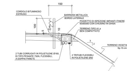
**SEZIONE TIPO CON CORSIA DI ACCELERAZIONE E DECELERAZIONE**
