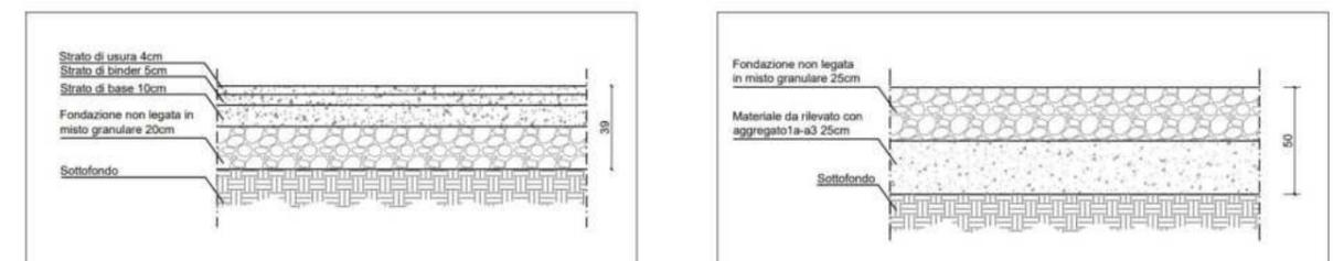
Figura 4.2.1.1: sezioni tipo dei due tratti di pavimentazione del percorso di manutenzione. A sinistra la pavimentazione impermeabile, a destra la pavimentazione permeabile
