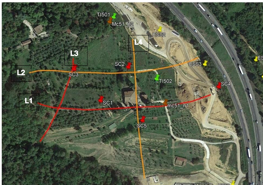
Figura 7-2 – Posizione planimetria delle verticali strumentate (coppie inclinometri + piezometri) installate nelle diverse fasi: in verde, indagini realizzate nell'ambito dei piani di monitoraggio ambientale anteoperam; in marrone quelle previste per il monitoraggio in corso d'opera. In rosso/arancio sono indicate le indagini integrative 2023; sono inoltre evidenziate le stese sismiche tomografiche (in onde P in rosso e in onde P + S in arancio). In giallo sono indicate le precedenti verticali di indagine di progetto più prossime al sito di interesse, oggi non più reperibili.
