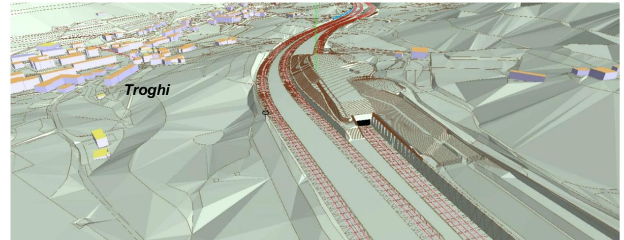
Figura 4-2: Vista 3D del modello geometrico ricostruito – Scenario con Nuova galleria artificiale (lunghezza pari a circa 210 m)
