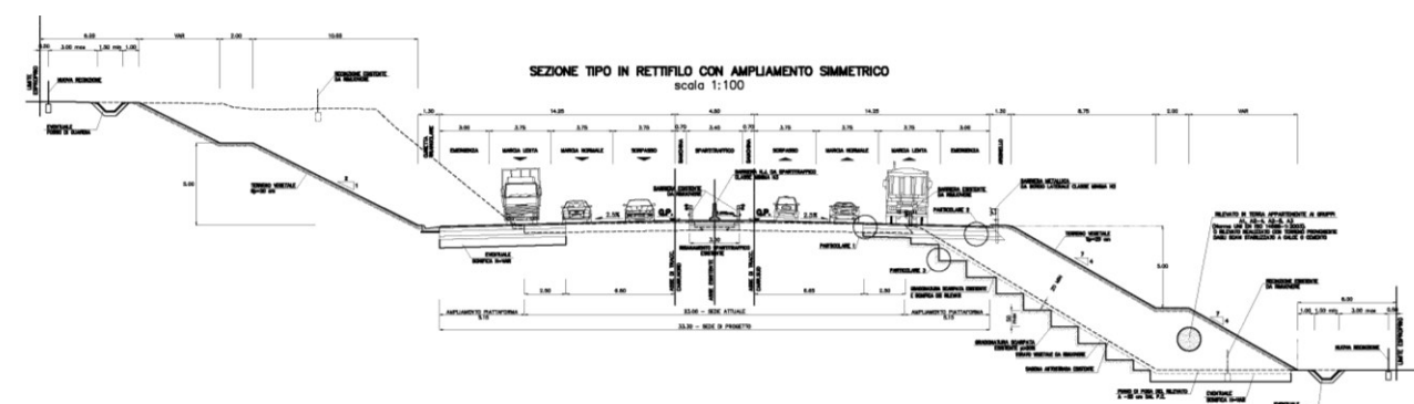
Figura 4-1 Sezione tipo in rettilineo con ampliamento simmetrico (per una maggiore lettura della sezione si rimanda agli elaborati di progetto definitivo)
