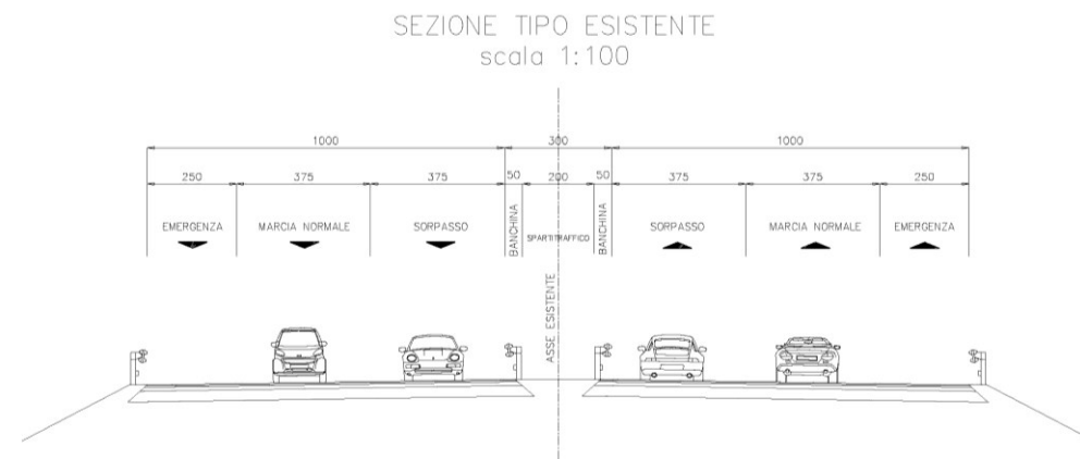
Figura 3-1 Sezione tipo piattaforma autostradale esistente
