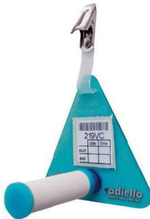
Lo ione ammonio viene determinato colorimetricamente sotto forma di indofenolo: in ambiente alcalino, lo ione ammonio reagisce con fenolo e ipoclorito di sodio, sotto l'azione catalitica del pentacianonitrosilferrato (cianoferrato), per formare indofenolo intensamente colorato in blu, la cui assorbanza è letta a 635 nm.
