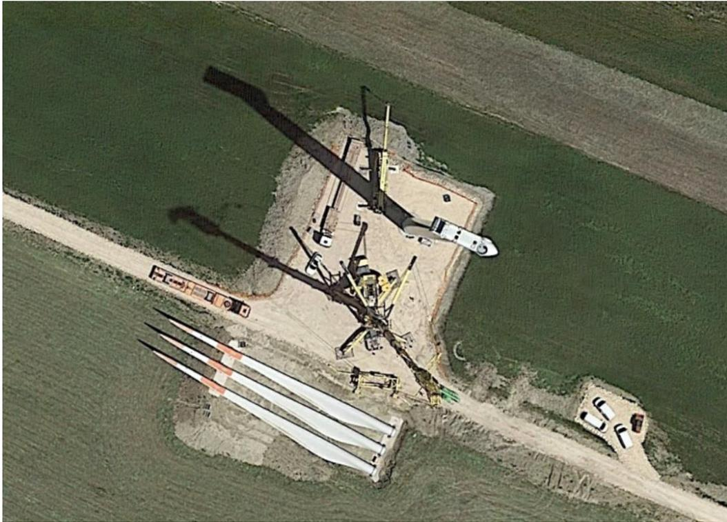
*Figura 4.18: esempio di piazzola in fase di costruzione*
