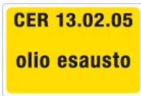
Figura 13 esempio cartellonistica di indicazione area di deposito
