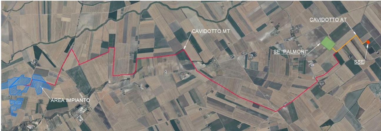
Figura 3 - Inquadramento percorso cavidotti MT e AT su ortofoto
